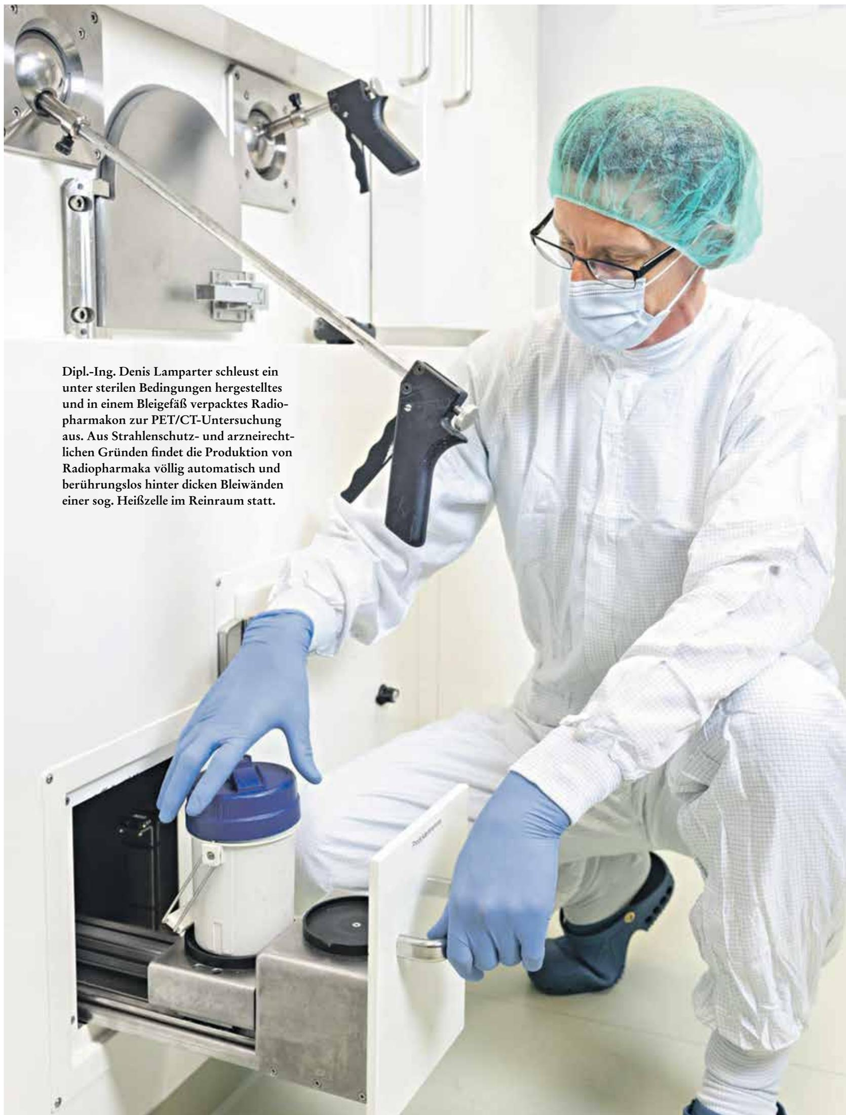
Dipl.-Ing. Denis Lamparter schleust ein unter sterilen Bedingungen hergestelltes und in einem Bleigefäß verpacktes Radiopharmakon zur PET/CT-Untersuchung aus. Aus Strahlenschutz- und arzneirechtlichen Gründen findet die Produktion von Radiopharmaka völlig automatisch und berührungslos hinter dicken Bleiwänden einer sog. Heißzelle im Reinraum statt.
