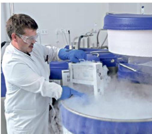
Kryolager für Stammzellen bei  $-140\text{ }^{\circ}\text{C}$ .
