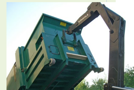
Verladung eines Abfallpresscontainers am UKW.
